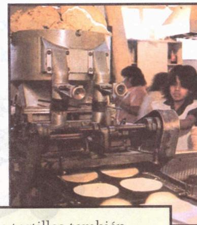
Las tortillas también se hacen en máquinas. Primero se pone una bola grande de masa en la máquina. Esta bola de masa pasa primero por unos rodillos que la aplanan. Después unos moldes recortan la masa en círculos, y finalmente los círculos pasan a una banda de lámina que los lleva adentro del horno. Al salir del horno, los círculos de masa ya son tortillas.
